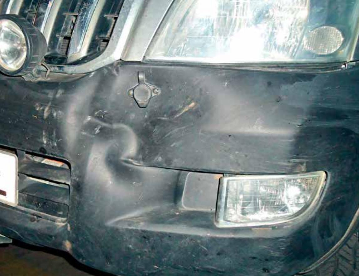
desmontarlo. Con un poco de paciencia, debemos localizar los puntos de sujeción y analizar las piezas que lo componen. Pequeños tornillos, encajes a presión y remaches de plástico nos pondrán a prueba para poder acceder a nuestro parachoques.
