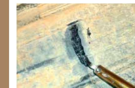
**5** Una vez desmontado el parachoques y alineadas las superficies a unir, aplicamos el soldador por la cara interior de la pieza para derretir el plástico de las dos partes a soldar.
