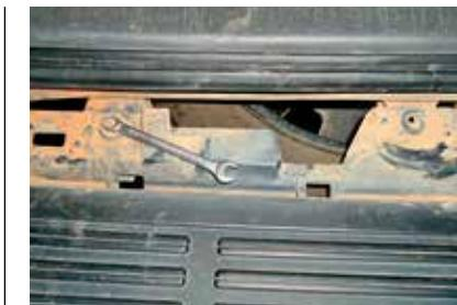
**2** Comenzamos a desmontar. Los tornillos nos lo pondrán fácil. Identificalos para asegurarte de no confundirlos a la hora de volver a montarlos.
