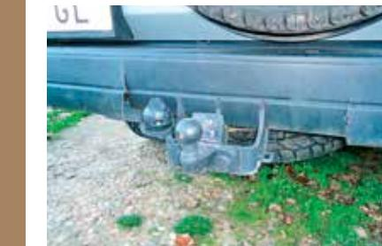
**1** El parachoques trasero de nuestro Land Cruiser tiene dos grandes rajaduras verticales. Sustituirlo es demasiado caro. Así que optaremos por desmontarlo y arreglarlo.
