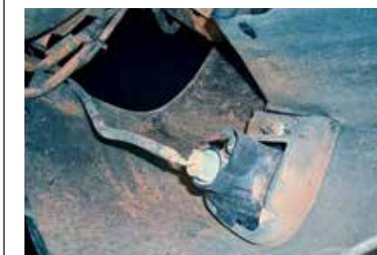
**4** Acuérdate de liberar cualquier conector eléctrico que encuentres antes de descolgar completamente el parachoques para evitar que los cables soporten el esfuerzo de sujetarlo.
