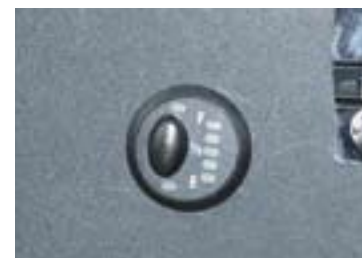
El depósito de combustible auxiliar, imprescindible para largas rutas, cuenta con este indicador adicional.
