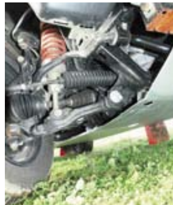
Amortiguadores regulables y la protección de cárter forman parte del KXR y han demostrado ser esenciales en una larga travesía.
