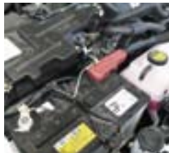
La doble batería (de serie en los KXR) fue imprescindible para asegurarnos que el motor de arranque haría su trabajo tras una dura jornada de cabrestante y luces auxiliares.
