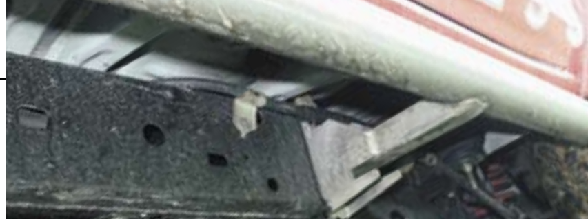
Ancladas al chasis, las barras laterales suponen una inestimable ayuda para usar el gato mecánico.
