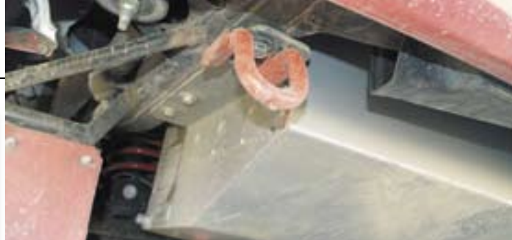
El depósito auxiliar de combustible (exclusivo de la preparación) se integra bien en los bajos.
