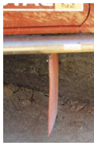
Los faldones son elementos muy asequibles que han evitado impactos en componentes vitales como los amortiguadores.
