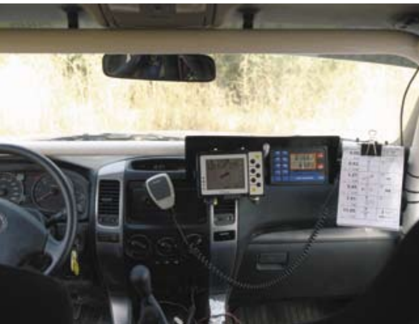
El salpicadero del KXR se diferencia por la ausencia del climatizador (reemplazado por un más simple equipo de aire acondicionado) y, en nuestro caso, la incursión de la jaula de seguridad.
