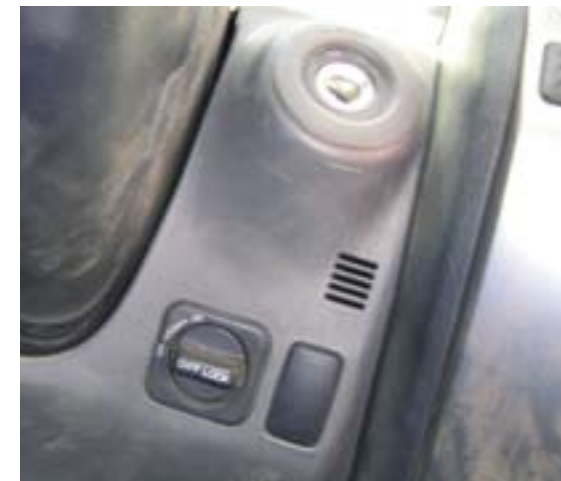
El mando del bloqueo del diferencial trasero diferencia a este Land Cruiser (junto con el KX) de sus compañeros de familia. El polvo y la arena recogidos durante la ruta se acumulan en cada rincón del vehículo.
