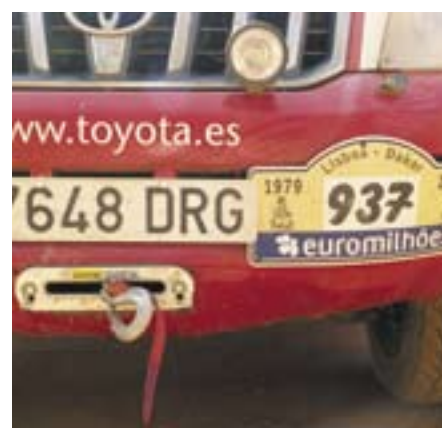
El cabrestante (elemento de serie del KXR) nos ayudó a salir de situaciones difíciles, pero recurrir a él con frecuencia supone desperdiciar un tiempo demasiado valioso.
