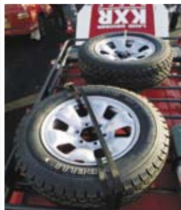
Inicialmente una encima de otra, las ruedas de repuesto se repartieron en la baca para mejorar el centro de gravedad y la aerodinámica.
