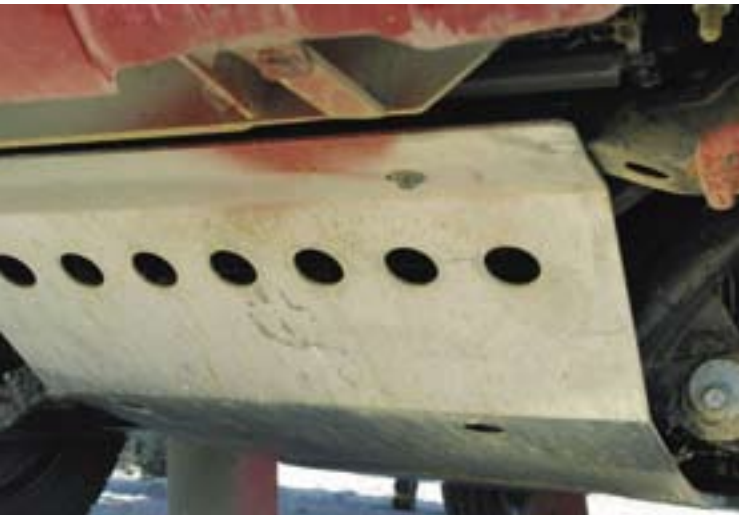
Todas las protecciones de los bajos son parte de la dotación de serie del Land Cruiser KXR. Con los vehículos tan cargados, fueron de gran ayuda.
