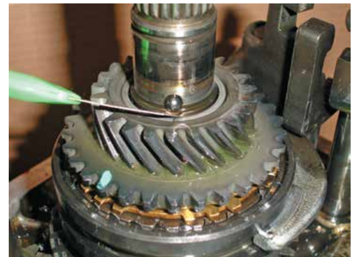
Estas pequeñas bolas de acero que bloquean la posición de algunos elementos tienden a salirse de su emplazamiento. Un poco de grasa nos permitirá mantenerlas "sujetas" y evitar que se pierdan.
