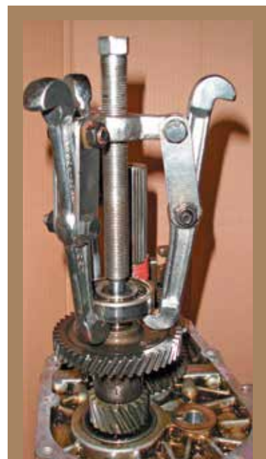
■ Los extractores nos permitirán desmontar las ruedas dentadas, los rodamientos y otros anillos. Cuando sea posible, utilizaremos el extractor de tornillo, pero si el espacio nos impide enganchar las garras, tendremos que contar con uno de guillotina.
