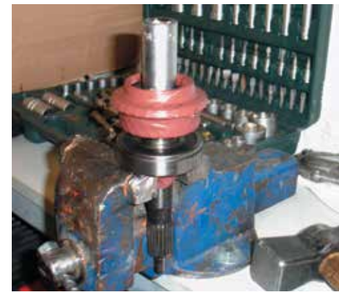
A falta de una prensa, podemos emplear el tornillo de un banco de trabajo y una maza. Como medida de precaución, encinta los engranajes antes de golpearlos para no dañarlos y emplea, a ser posible, una maza de nailon.
