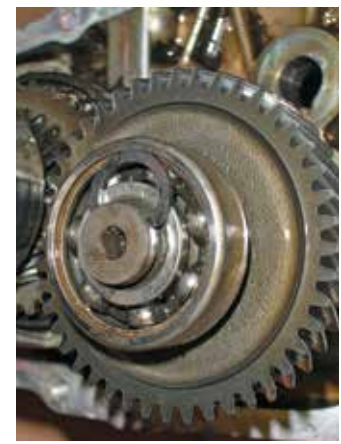
Los clips o anillos de acero bloquean el desplazamiento de los engranajes a lo largo del eje. Cuando montes la caja, no los reutilices. Son muy baratos y pueden causar una avería catastrófica.
