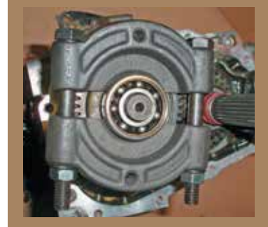
■ Los extractores nos permitirán desmontar las ruedas dentadas, los rodamientos y otros anillos. Cuando sea posible, utilizaremos el extractor de tornillo, pero si el espacio nos impide enganchar las garras, tendremos que contar con uno de guillotina.
