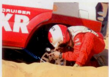
Para obtener la máxima tracción es necesario ajustar la presión de los neumáticos (en torno a 0,8 kg/cm 2 ).
