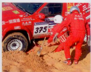
Una vez extraída la arena, colocaremos las planchas por delante de la rueda en el sentido en el que vayamos a mover el vehículo.
