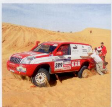
Primera-reductora, gas a fondo (sin jugar con el embrague) y un empujón serán suficientes para liberar el vehículo.
