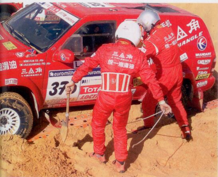
Con la incorporación de una cuerda y un testigo podremos recuperar las planchas si quedan enterradas en la arena después de liberar el vehículo.
