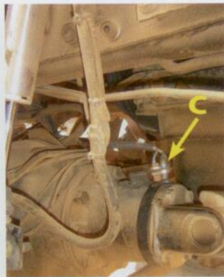
Para captar los impulsos de los giros que realiza la transmisión, tendremos que incorporar un tetón o una lengüeta (B) en la parte móvil de dicho elemento para que puedan ser percibidos por sonda (A). En competición es habitual colocar dos sondas (C) para garantizar la fiabilidad del dispositivo.
