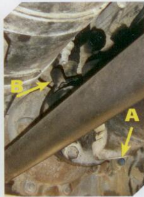
Para captar los impulsos de los giros que realiza la transmisión, tendremos que incorporar un tetón o una lengüeta (B) en la parte móvil de dicho elemento para que puedan ser percibidos por sonda (A). En competición es habitual colocar dos sondas (C) para garantizar la fiabilidad del dispositivo.
