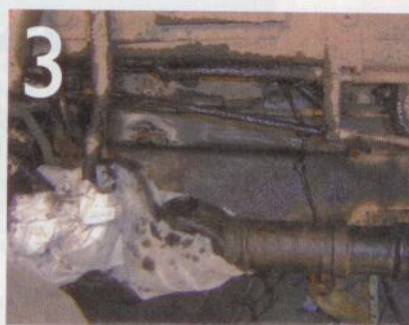
3 Es imprescindible limpiar a conciencia la zona a reparar, especialmente si presenta restos de grasa.
