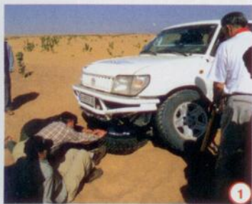
1 Después de elevar el vehículo, hay que afianzar la posición para trabajar de forma segura.
