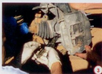
3 Comprobamos el origen de la avería. Se rompió uno de los tornillos que unen la mangueta con el triángulo inferior.
