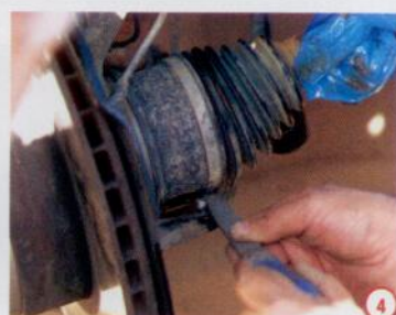
4 Para retirar este tornillo hubo que realizar dos planos en la parte final de la rosca.
