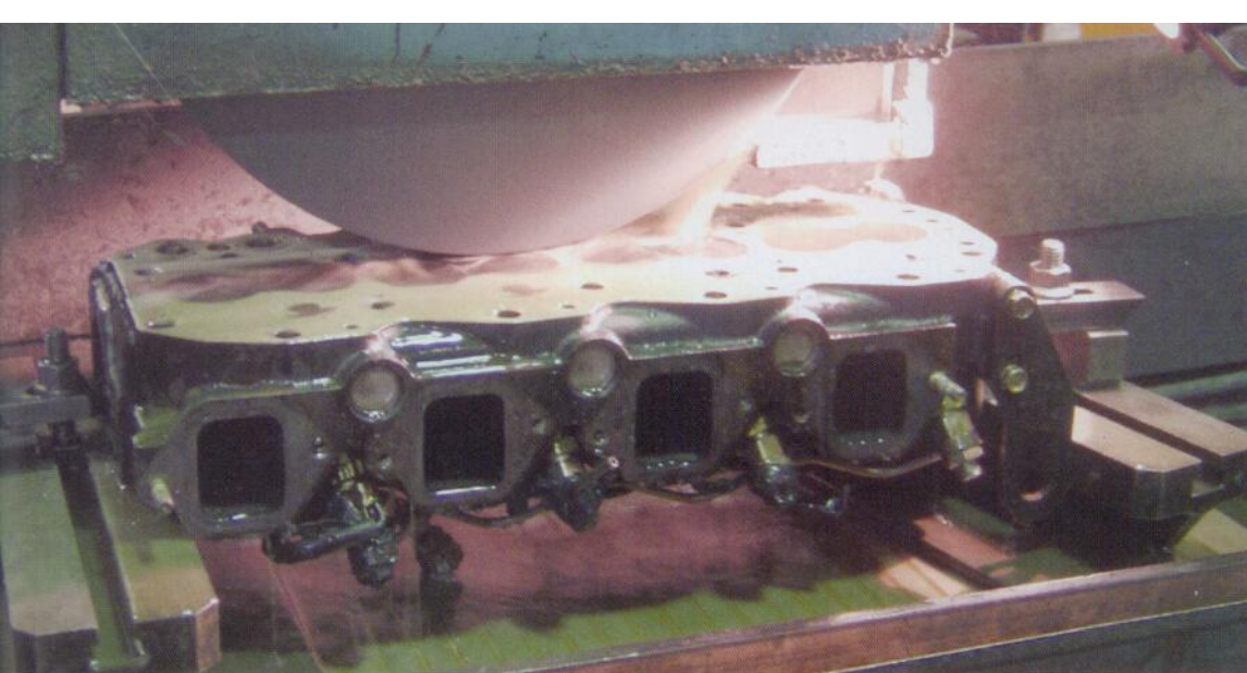
El rectificado consiste en suprimir unas décimas de milímetro de la superficie de la culata con una piedra de pulir calibrada.
