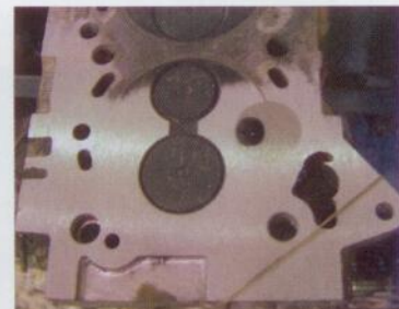
En la imagen superior puede observarse cómo el primer desbaste no ha alcanzado toda la superficie de la culata, indicando que ésta se había curvado. A la izquierda, una culata rectificada y lista para volver a montarse.
