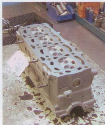
Una subida drástica de la temperatura del motor puede dañar la junta (arriba), la culata (derecha) o ambas.
