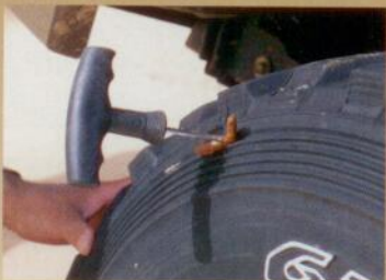
Una vez colocada la horquilla en el neumático, empujaremos lentamente.
