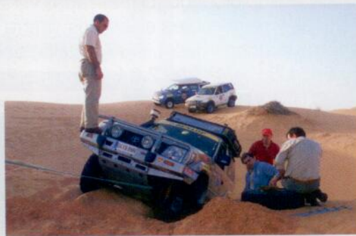
El contrapeso, la eslinga y el hoyo nos permiten retirar la rueda in situ . Conviene que en la operación participen más de dos personas.
