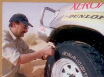
Detectado el pinchazo, hay que usar el punzón para introducir el material de reposición.
