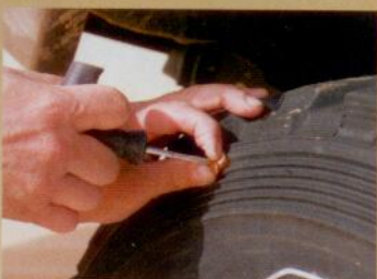
Para evitar que la goma a vulcanizar caiga dentro, hay que sujetarla.
