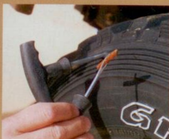
Debemos sincronizar la retirada del punzón y la introducción de la horquilla.
