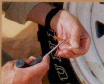
La goma virgen se coloca en la horquilla para introducirla en el orificio del pinchazo.
