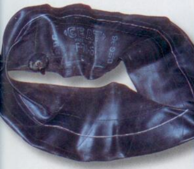
Las cámaras son necesarias para recuperar la estanqueidad de una goma cortada.
