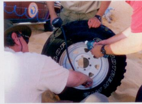
Si la rueda se ha deslantado, hay que limpiar el perímetro para que ajuste de nuevo con la llanta.
