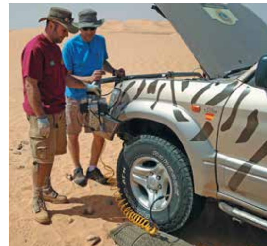
El compresor resulta un valioso “complemento” de la rueda en rutas africanas, donde poder jugar con las presiones es crucial para tener tracción en arena y resistencia a los pinchazos en piedras. Las válvulas “taradas” nos ayudarán a desinflar controladamente los neumáticos.
