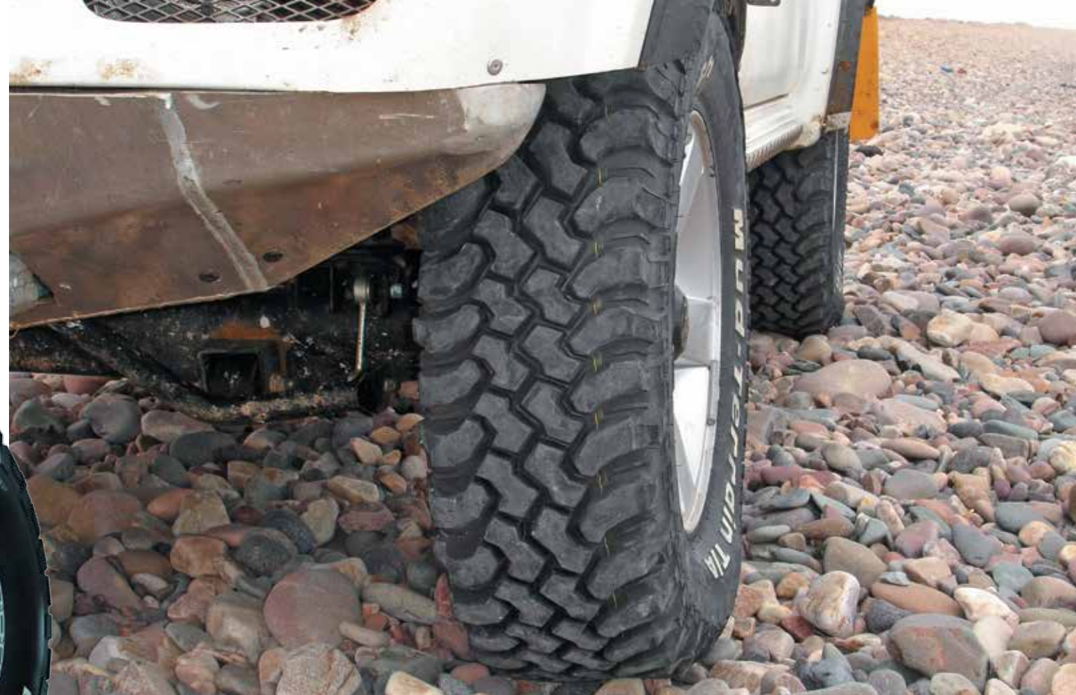
El compresor resulta un valioso “complemento” de la rueda en rutas africanas, donde poder jugar con las presiones es crucial para tener tracción en arena y resistencia a los pinchazos en piedras. Las válvulas “taradas” nos ayudarán a desinflar controladamente los neumáticos.
