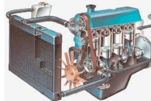
En los prototipos trialeros (imagen superior) es habitual montar el radiador en posición elevada para evitar la rotura del electroventilador durante los vadeos. Antiguamente, el motor térmico movía directamente el ventilador del sistema de refrigeración (arriba). El sensor de temperatura (abajo) es el encargado de accionar el electroventilador.
