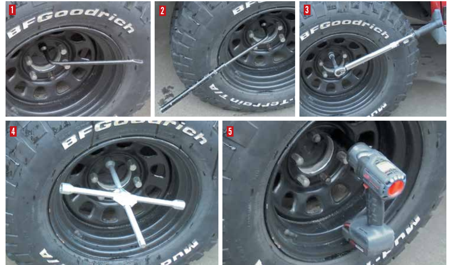
La llave fija acodada (1) es suficiente para apretar adecuadamente las tuercas sin tener que hacer un esfuerzo extraordinario, pero a veces no resulta sencillo aflojarlas con esta herramienta. Duplicar el brazo de palanca con una extensión (2) puede ser una buena idea, pero nunca para aumentar el par de apriete. De cara a lograr el par de apriete exacto, la llave dinamométrica (3) es la mejor solución. La cruceta (4) permite aplicar la fuerza mediante dos vectores de sentidos opuestos, por lo que es ideal cuando, como en este caso, gestionamos pares de fuerzas. Finalmente, la pistola de impacto (5) resulta la solución más cómoda y eficaz.
