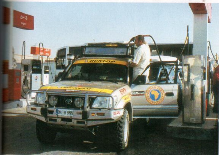
Con el calor, el combustible se dilata. Esto hay que tenerlo en cuenta a la hora de repostar y no llenar el tanque a tope para evitar vertidos a la calzada.
