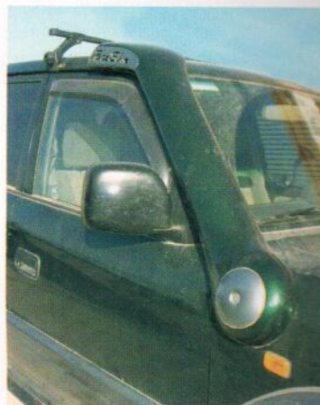
La toma elevada es la medida más eficaz para mantener el filtro de aire limpio.
