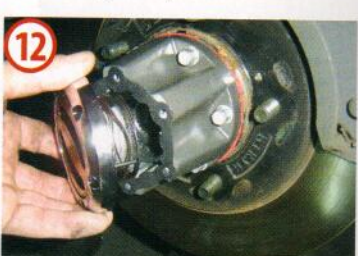
12 Al colocar el mando, hay que hacer coincidir el vástago con la ranura del cuerpo de bloqueo.
