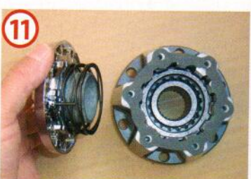
11 Si los rebajes no coinciden, el vástago del mando no entrará en el cuerpo de bloqueo.
