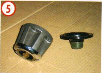
5 A la izquierda se observa el sistema de bloqueo manual y a la derecha el fijo original.
