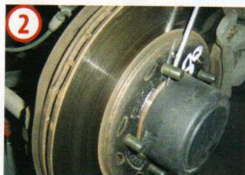
2 Retirando la tapa de plástico, podemos acceder a la pieza de bloqueo original.
