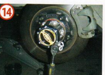
14 Antes de dar el trabajo por finalizado, conviene reapretar toda la tornillería.
