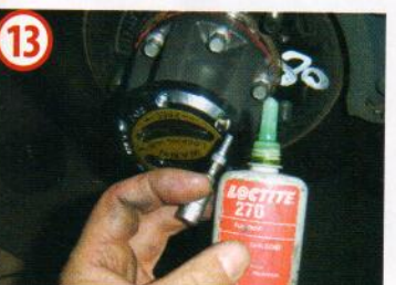
13 Aplicando un poco de fijador, evitaremos que los tornillos se aflojen con las vibraciones.
