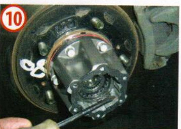
10 Al colocar la junta se debe tener cuidado para que coincida el rebaje del cuerpo de bloqueo.
