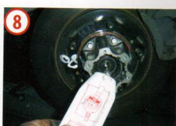
8 Añadiendo un poco de grasa sólida, facilitaremos el trabajo de las partes móviles.
