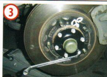
3 Los tornillos que sujetan la pieza original se reutilizan para el montaje del nuevo sistema.
