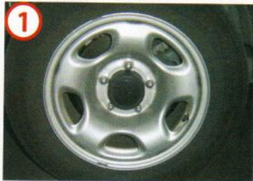
1 Para instalar el liberador, hay que elevar el vehículo y retirar la rueda.
