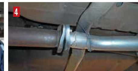
La rotura de un soporte ha dejado suelto el escape y ha hecho que se rompa su tramo final (6). Ataremos la parte superviviente al chasis (4) y soldaremos un nuevo soporte tan pronto como sea posible (3 y 5).
