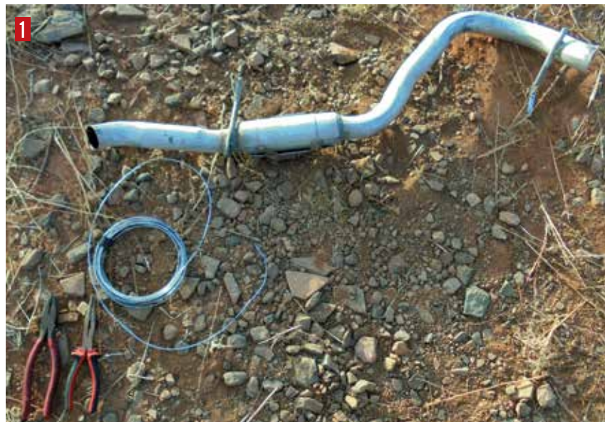
El mal ya está hecho. Ahora hay que minimizar sus consecuencias. Siempre debemos llevar un rollo de alambre y unos alicates. En este caso, nos servirá para sujetar al chasis la parte de la línea de escape que aún no se ha roto.
