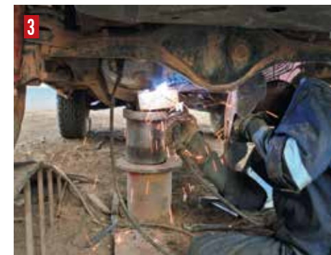
La rotura de un soporte ha dejado suelto el escape y ha hecho que se rompa su tramo final (6). Ataremos la parte superviviente al chasis (4) y soldaremos un nuevo soporte tan pronto como sea posible (3 y 5).
