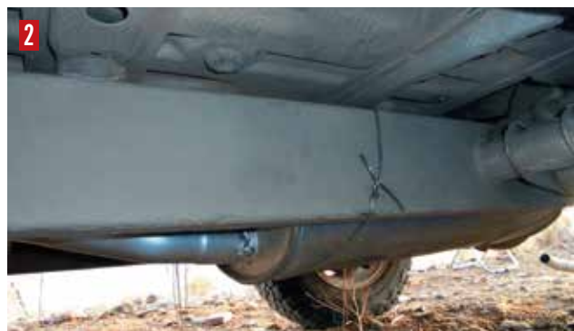
El mal ya está hecho. Ahora hay que minimizar sus consecuencias. Siempre debemos llevar un rollo de alambre y unos alicates. En este caso, nos servirá para sujetar al chasis la parte de la línea de escape que aún no se ha roto.
