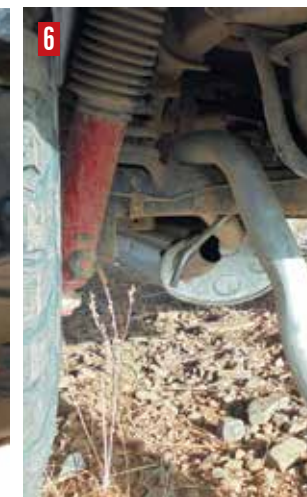
La rotura de un soporte ha dejado suelto el escape y ha hecho que se rompa su tramo final (6). Ataremos la parte superviviente al chasis (4) y soldaremos un nuevo soporte tan pronto como sea posible (3 y 5).
