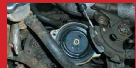
3 Una vez extraídos los tornillos y la tapa, tendremos acceso a la membrana. Hay que ser extremadamente cuidadosos, ya que si la perforamos o dañamos, deberemos sustituirla.
