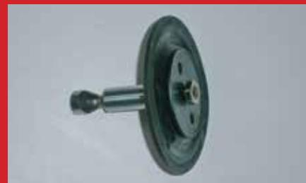
5 A continuación, desmontamos la membrana de la leva.
