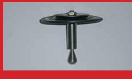
7 Montamos la nueva leva con la válvula y volvemos a colocar el conjunto en su sitio, instalando la tapa a continuación y conectando el tubo de sobrepresión.
