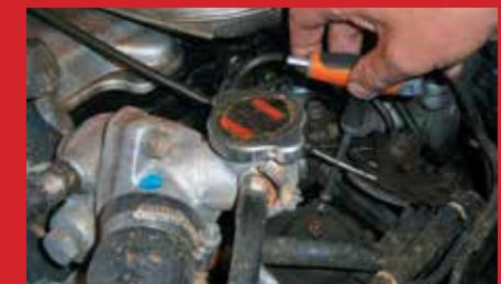
2 A continuación, debemos retirar los cuatro tornillos que aseguran la tapa del fuelle neumático.
