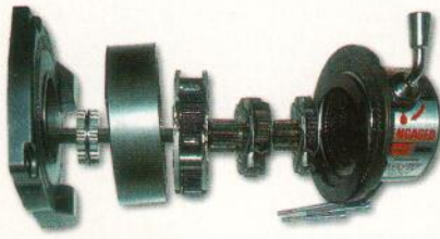
Caja reductora. Sus engranajes planetarios desmultiplican hasta 250 veces el giro del motor.
