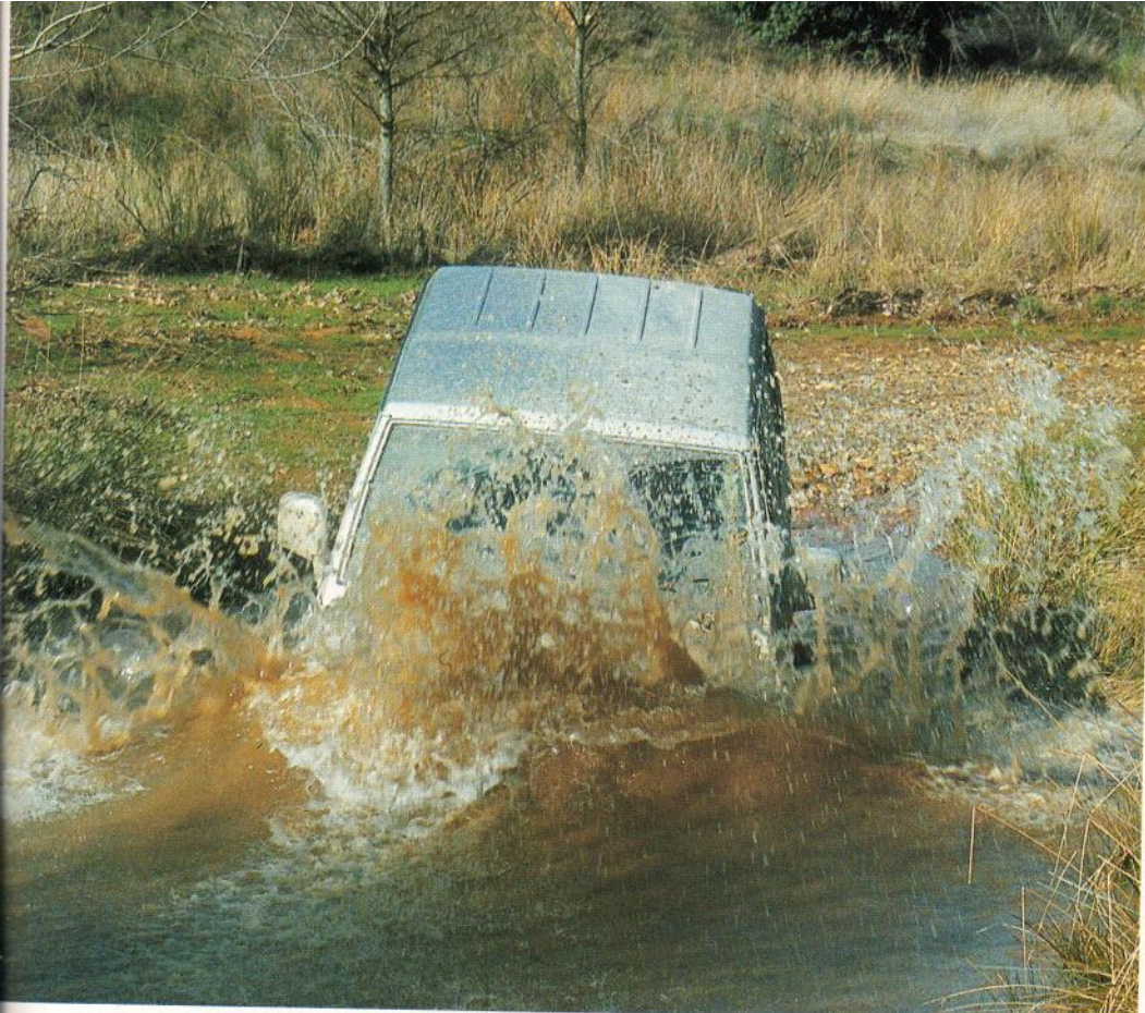
La ola que se forma delante del vehículo al entrar en el agua con velocidad puede provocar la entrada de agua en el motor.
