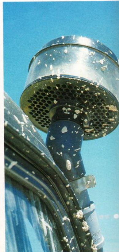
Instalación de un separador ciclónico en la boca de aspiración.
