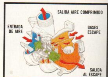
Funcionamiento de un turbocompresor.
