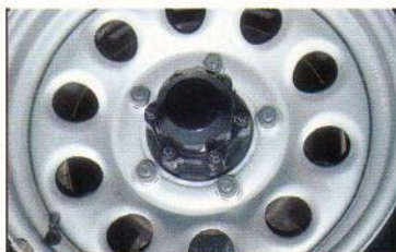
Vista exterior e interior del sistema de liberadores electroneumáticos.
