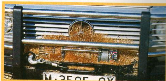
▲ La suciedad acumulada ocasiona problemas en el sistema de refrigeración.
