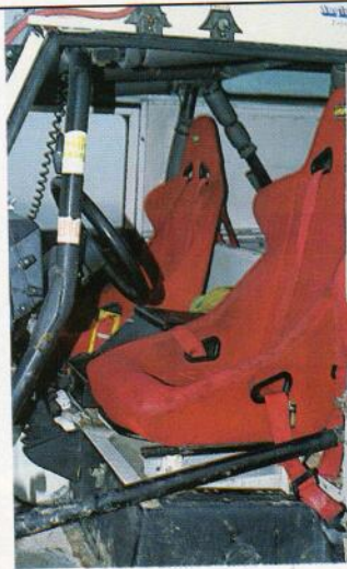
◀ El arco de seis puntos protege el habitáculo del piloto y copiloto
