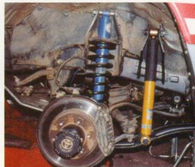
Los soportes del segundo amortiguador deben ser igualmente resistentes.
