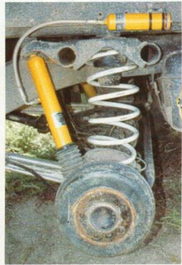
Una vez que hemos instalado el amortiguador, hay que ubicar la botella de gas.
