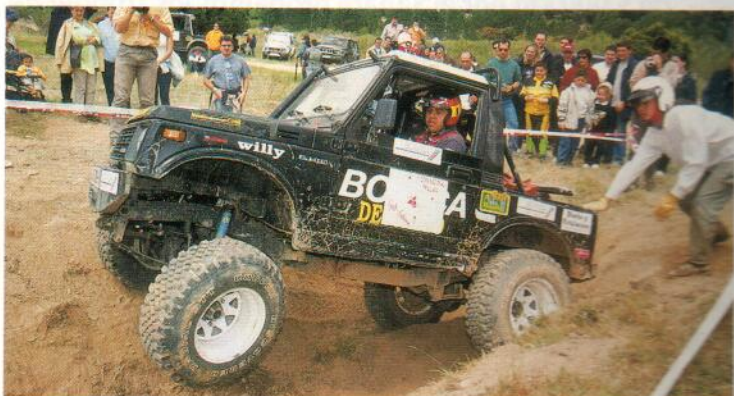
Los cruces de puentes provocan en ocasiones estiramientos excesivos de los amortiguadores.
