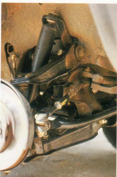
Los sistemas de suspensión independientes incorporan topes de goma en extensión y en compresión.
