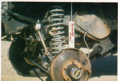
La estabilizadora limita el recorrido de la suspensión.
