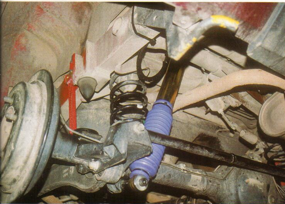
Para proteger el amortiguador hay que colocar un limitador de extensión.
