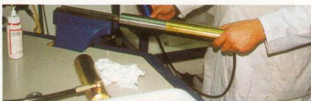
Antes de empezar a montar el amortiguador se comprueba si el tubo está deformado.
