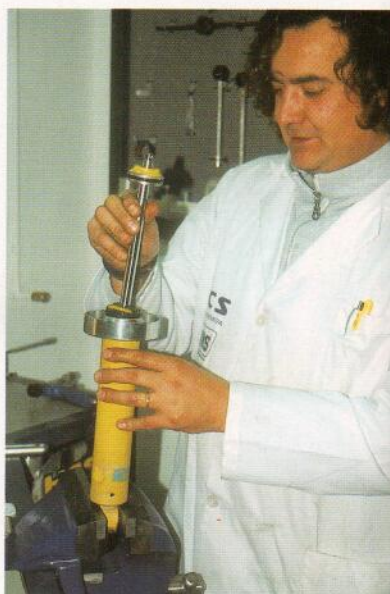
La primera operación es desmontar meticulosamente el amortiguador.
