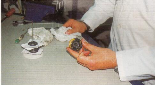
El tope en extensión de los amortiguadores traseros estaba fundido y clavado en los agujeros de paso de aceite del pistón.
