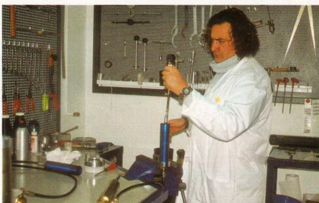
El proceso concluye con la carga de gas de la botella.
