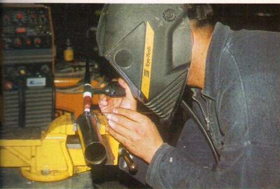
Al tubo hay que soldarle un manguito roscado para posteriormente ensamblar el latiguillo que lleva el aceite a la botella.
