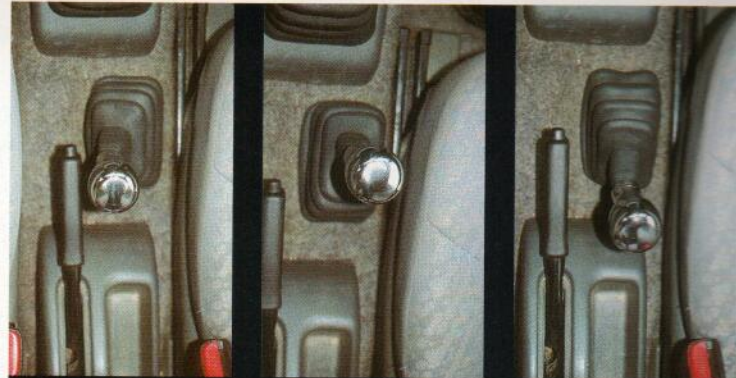
Recorrido de la palanca de la transfer del Mil instalada en el Jimny.
