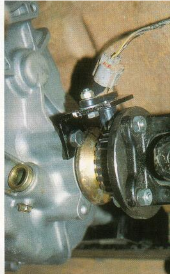
La reductora del "Mil" necesita instalar un sensor para el velocímetro.
