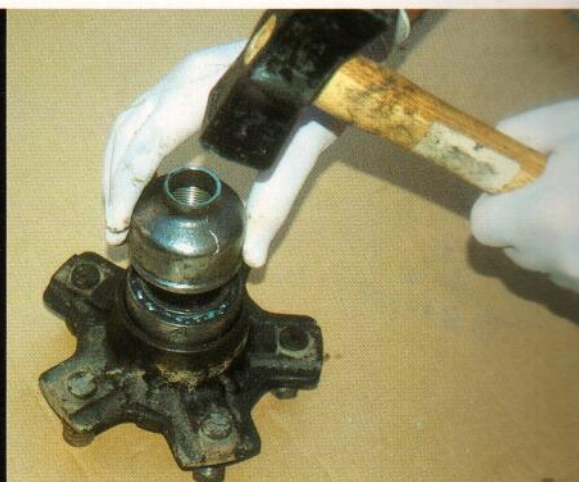
Si no tenemos recambio, conviene extremar las precauciones al extraer el retén.
