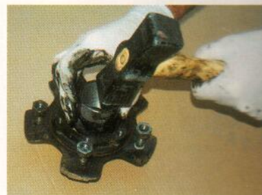
Para sacar el rodamiento hay que golpear sobre la pista interior o sobre la exterior.
