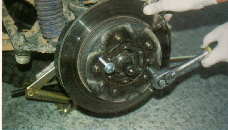
Para despegar el disco podemos ayudarnos con dos tornillos auxiliares.
