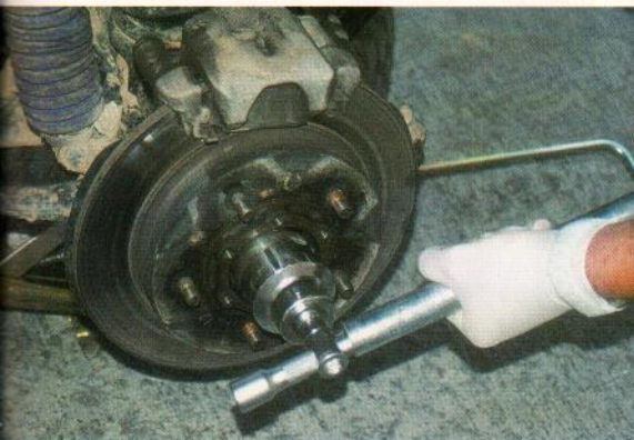
Un movimiento transversal del disco sirve para determinar si hay holguras.
