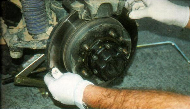
Un movimiento transversal del disco sirve para determinar si hay holguras.
