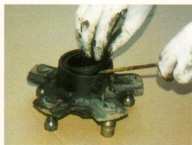
Si no tenemos recambio, conviene extremar las precauciones al extraer el retén.
