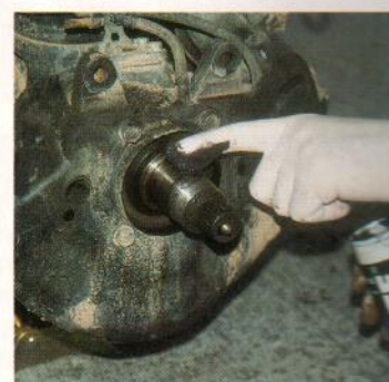
A la hora de proceder a la instalación del conjunto conviene añadir una grasa especial para rodamientos.
