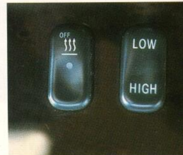
En modelos como el Mercedes G o los SsangYong la reductora se conecta mediante un interruptor.
