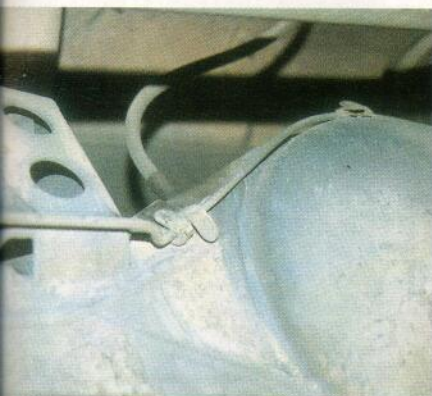
Los respiraderos de los ejes, cajas de cambios y transfer hay que conducirlos a un punto elevado.
