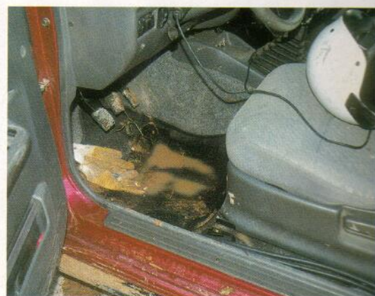
La estanqueidad de las puertas y los bajos no impide la entrada de agua.
