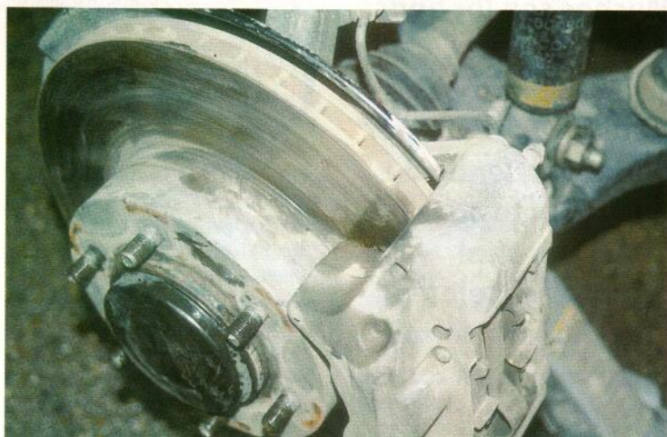
Los discos ventilados incorporan en las superficies de fricción unos álabes que fuerzan el paso del aire.
