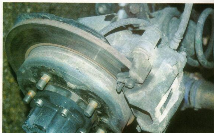
Los discos de freno macizos son más propensos a los calentamientos, apareciendo antes el fading.
