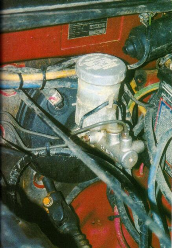
El servofreno tiene la misión de aliviar parte del esfuerzo necesario que hay que realizar sobre el pedal del freno.
