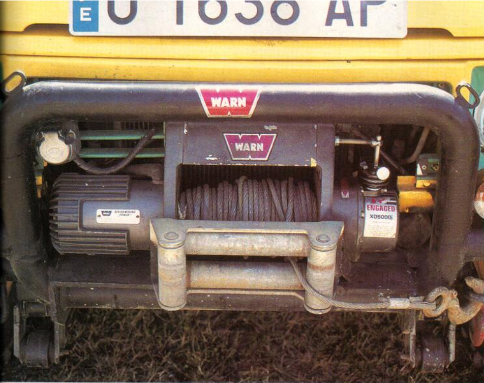
El cabrestante sirve tanto para remolcar como para ser remolcados. Su presencia suele ser llamativa y su trabajo eficaz.
