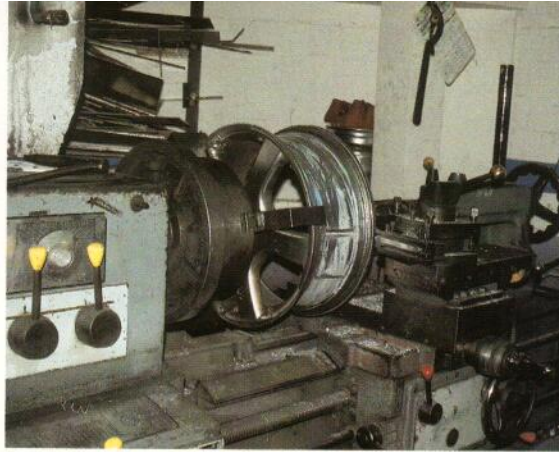
En el torno, la llanta recupera su forma original.
