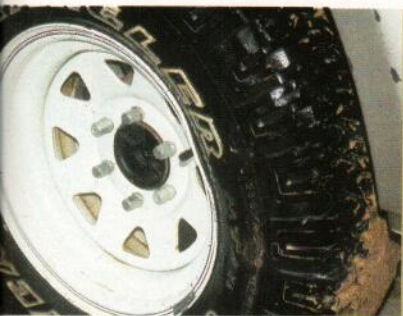
Las llantas de chapa se pueden reparar 'in situ' con una maza, sin recuperar la estanqueidad de la goma, por lo que es necesario incorporar una cámara.
