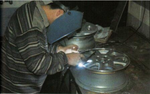
Para soldar las aleaciones, se requiere un operario especializado.
