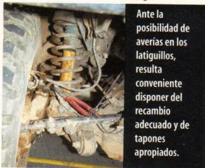
Los latiguillos metálicos son más resistentes y adecuados para un todoterreno que los clásicos de goma.
