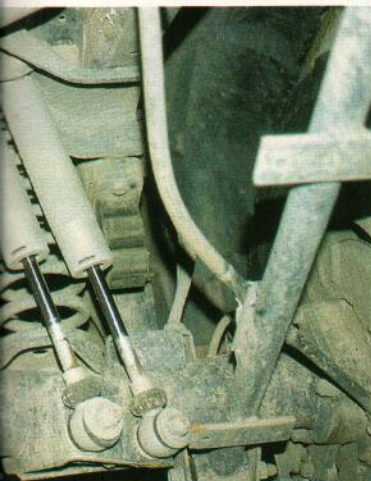
Al instalar el doble amortiguador, debemos verificar otros elementos, como los latiguillos de los frenos o el recorrido de la dirección.
