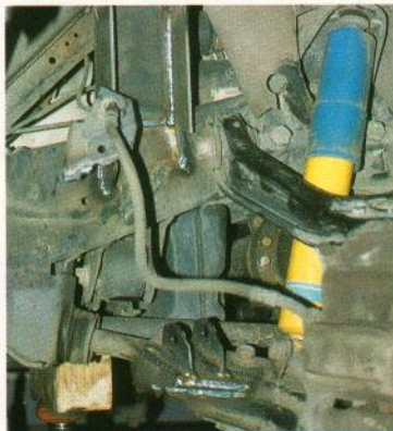
Al instalar el doble amortiguador, debemos verificar otros elementos, como los latiguillos de los frenos o el recorrido de la dirección.
