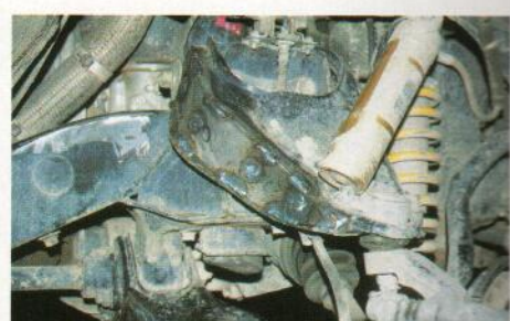
El refuerzo de los triángulos de la suspensión independiente requiere un laborioso trabajo, propio de un taller especializado.
