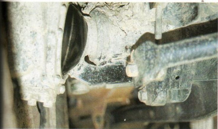
La carcasa de las juntas homocinéticas constituye la parte más débil de los ejes. Reforzarla es fácil mediante una gruesa placa de hierro.
