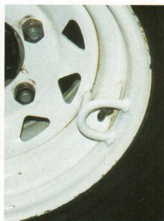
Los pequeños detalles también son importantes, como proteger las válvulas.
