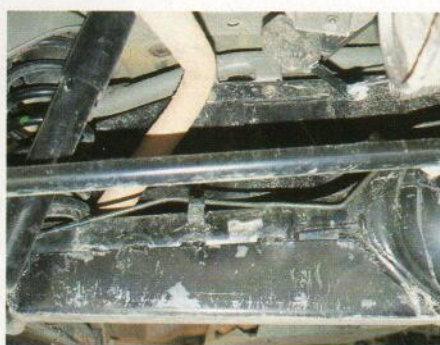
Las suspensiones muy duras provocan vibraciones que afectan al chasis. Evitarlo es sólo cuestión de regular bien la amortiguación.
