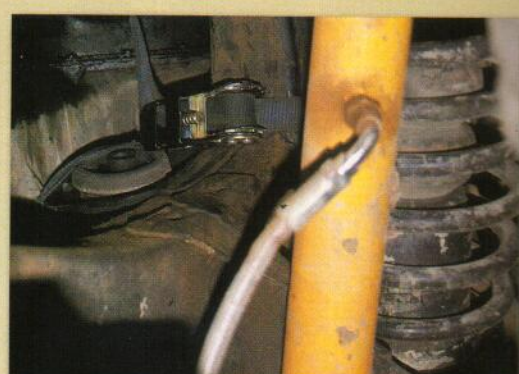
Como medida de emergencia, podemos utilizar una pequeña cinta para sujetar un silentblok roto.
