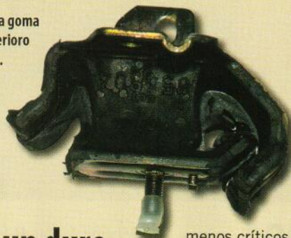
Cuando se rompen, los silentblocks permiten desplazamientos que provocan averías mecánicas.
