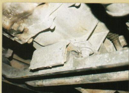
Cuando se rompen, los silentblocks permiten desplazamientos que provocan averías mecánicas.
