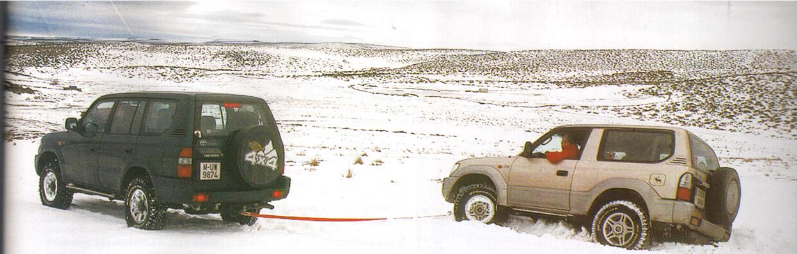
Sobre superficies deslizantes, la eslinga y un corto tramo adherente son de gran ayuda.
