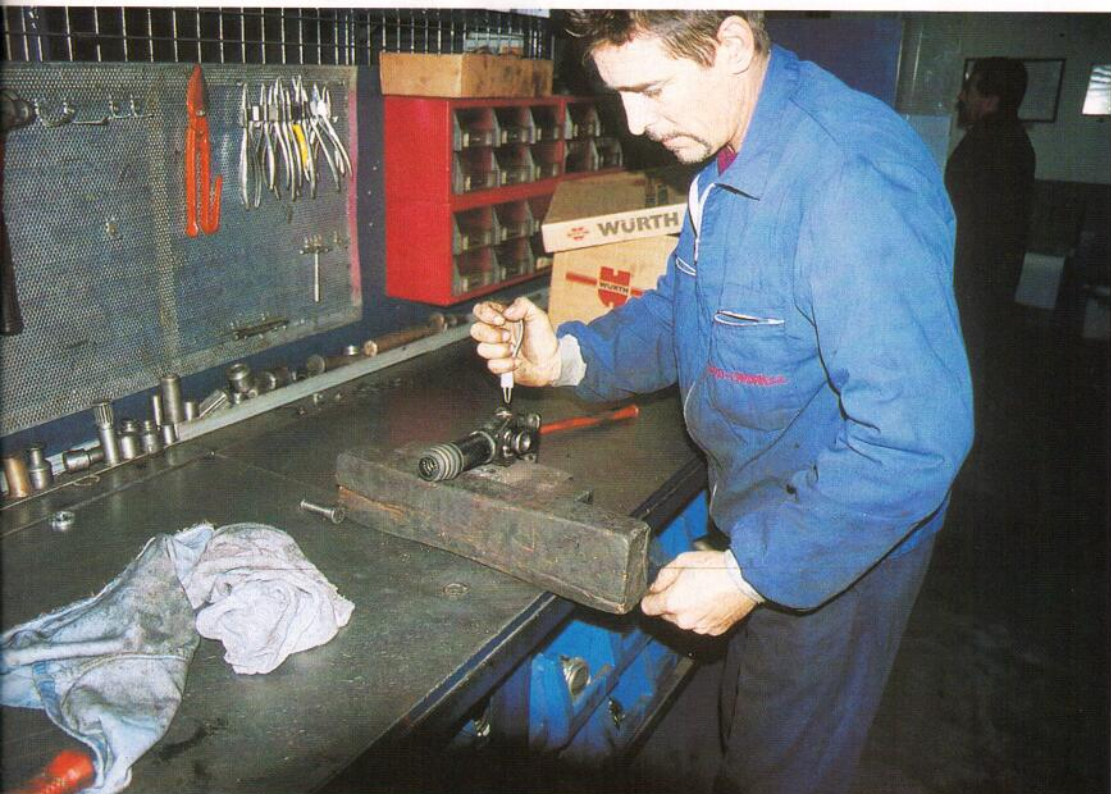
El cambio de las crucetas, engorroso para un usuario, es sencillo con los medios de un taller especializado (Iberocardan).
