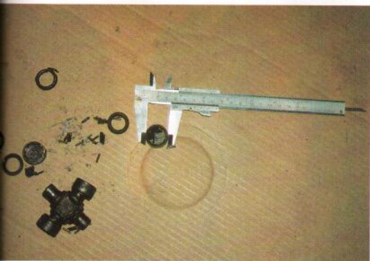
Una vez desmontada la cruceta, hay que utilizar un calibre para determinar sus dimensiones exactas.
