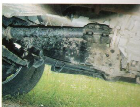
La incorporaci n de una cruceta doble facilita los  ngulos de transmisi n acusados, reduce vibraciones, ruidos y alarga la vida de este elemento mec nico.
