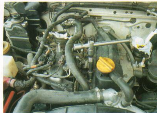
Para acceder a los calentadores de algunos turbodiésel, hay que desmontar el intercooler.
