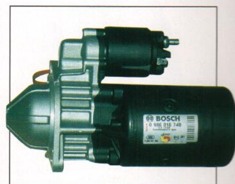
El mal estado del relé y de las escobillas del motor de arranque nos puede dejar tirados
