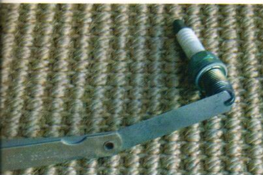
La separación de los electrodos de la bujía permite que la chispa salte en el momento adecuado y disponga de la fuerza suficiente para provocar las explosiones en el motor.
