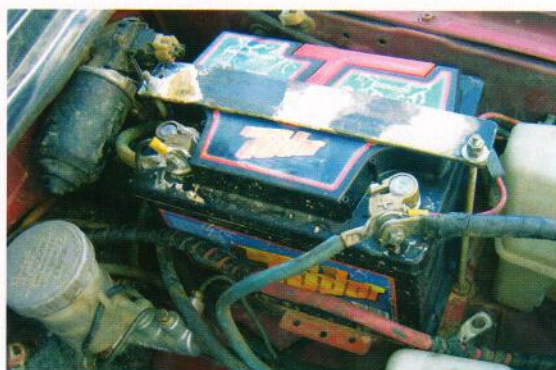
Una de las principales víctimas del frío es la batería. El sulfatado de los bornes reduce el tránsito del fluido eléctrico.
