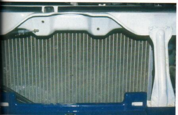
Un radiador limpio garantiza el flujo de aire y permite mantener la temperatura de la mecánica en torno a los 90 grados.
