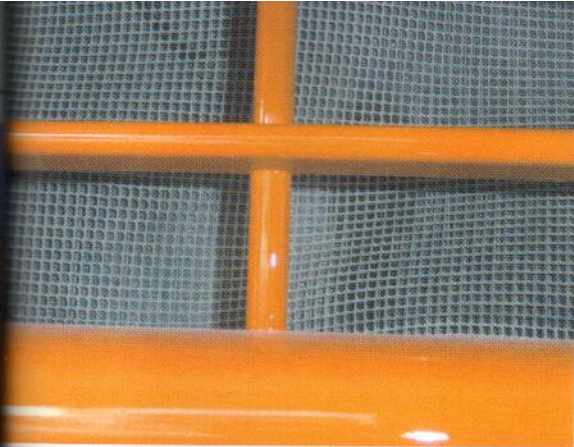
Una rejilla protege de restos de maleza que fácilmente a veces se introducen en las aletas de refrigeración del radiador.
