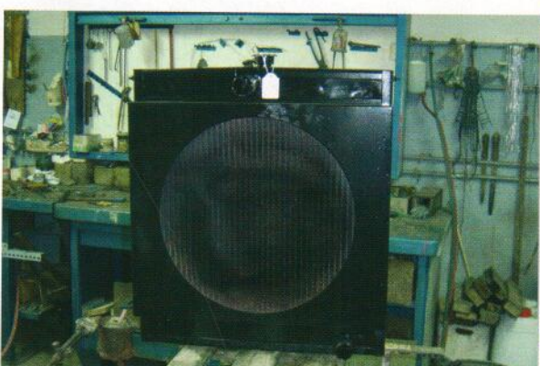
Una vez reparado el radiador, si éste es de cobre se termina con una mano de pintura anticorrosiva.
