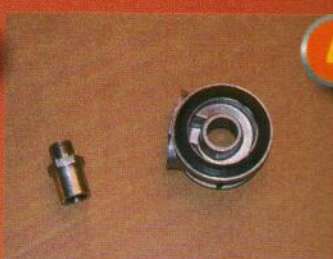
La pieza clave de todo el trabajo es el derivador de flujo que se instala entre el bloque y el filtro de aceite.
