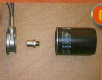
Una pieza con una rosca interior y otra exterior permite sujetar el derivador al bloque motor y, a su vez, al filtro de aceite.
