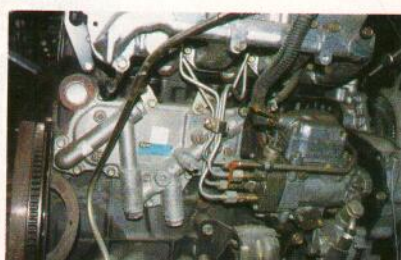
El motor 2.7 del Nissan Terrano dispone de un intercambiador aceite-agua instalado en un costado del bloque.
