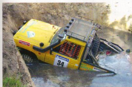
Los perjuicios del agua sobre la mecánica se pueden evitar elevando la toma de admisión y los respiraderos de diferenciales y trófer.
