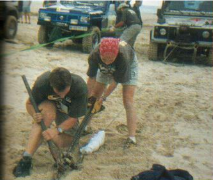
Como tráctel, el gato mecánico es útil, pero resulta muy lento y engorroso de manejar.
