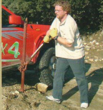
A la hora de utilizar el gato mecánico, hay que mantenerse alejado de la palanca y sujetarla con firmeza. Conviene ponerse guantes.
