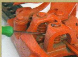
El gato mecánico no necesita estar engrasado, pero sí lubricado con un spray.
