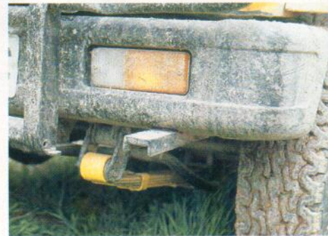
Al instalar los soportes hay que evitar que sobresalgan del parachoques para no tener problemas en la ITV.
