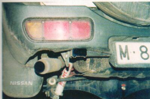
El diseño de los soportes es una labor meticulosa. En la imagen se observa una buena solución para la parte posterior de un Terrano.
