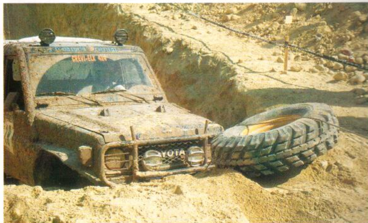
Cuando utilizemos el cabrestante, debemos asegurarnos de que el ángulo de tiro es el idóneo. Si no es así, podremos recurrir a nuestro equipo para modificarlo.
