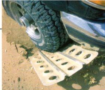
La textura y los desniveles del terreno pueden ser modificados mediante las planchas.
