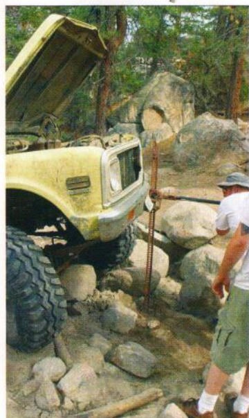
En las zonas de piedras, antes de arrastrar el vehículo con el winch hay que franquear el camino a los elementos mecánicos vulnerables.
