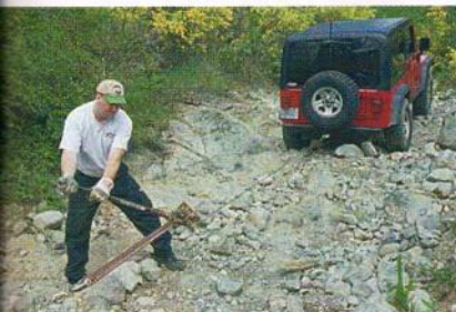
El ingenio permite utilizar ciertos recursos de la forma más eficaz, como por ejemplo el Hi-Lift como improvisado cabrestante.
