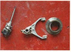
En las cajas con accionamiento motorizado, es frecuente que ese accionamiento ceda antes que la propia caja. En esos casos, la caja seguirá funcionando, pero no podremos conectar la reductora o el bloqueo del diferencial central.
