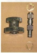
Debido a su reducido tamaño, los rodamientos de aguja del eje de engranajes intermedio sufren mayor desgaste que los propios engranajes, por lo que, si abrimos la tránsfer, es muy recomendable reemplazarlos, aunque aparentemente se encuentren en buen estado.
