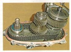
La caja tránsfer sirve tanto para desmultiplicar la fuerza del motor como para enviar par al eje que normalmente permanece desconectado (casi siempre es el delantero). Este reenvío puede hacerse mediante una cascada de engranajes (más fiable) o utilizando una cadena.
