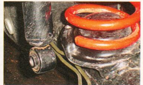
Los soportes inferiores convencionales de los todoterrenos de serie dan acomodo al muelle pero no están pensados para retenerlo ni para re-colocarlo si se desplaza. Para un uso extremo, es conveniente corregir este aspecto.
