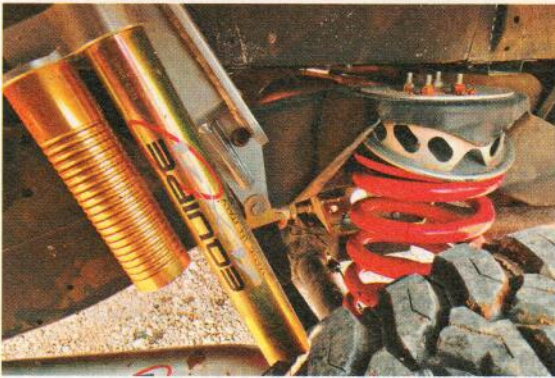
En los todoterrenos con ejes rígidos, es posible contar con recorridos de suspensión muy amplios que permitan que el muelle se desacople de su soporte superior. Un asiento desplazable facilita el reencuentro entre el muelle y el bastidor.
