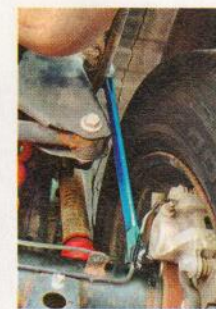
Los soportes inferiores convencionales de los todoterrenos de serie dan acomodo al muelle pero no están pensados para retenerlo ni para re-colocarlo si se desplaza. Para un uso extremo, es conveniente corregir este aspecto.
