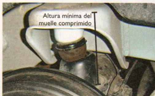
A la hora de reemplazar los muelles por otros de diferentes especificaciones, comprobaremos que la altura del muelle completamente comprimido sea siempre inferior a la distancia entre los soportes inferior y superior del muelle. En caso necesario, deberemos cambiar los topes de goma por otros más altos y rígidos. Así, en el caso de una fuerte compresión, el muelle no dejará de conservar su estado elástico.
