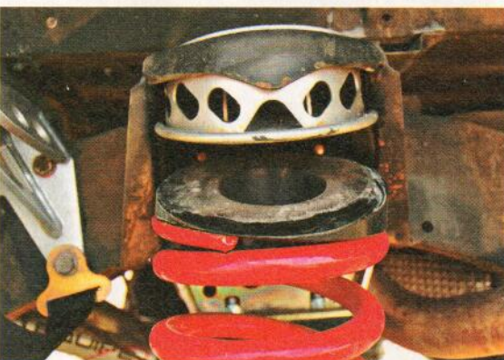
A la hora de reemplazar los muelles por otros de diferentes especificaciones, comprobaremos que la altura del muelle completamente comprimido sea siempre inferior a la distancia entre los soportes inferior y superior del muelle. En caso necesario, deberemos cambiar los topes de goma por otros más altos y rígidos. Así, en el caso de una fuerte compresión, el muelle no dejará de conservar su estado elástico.
