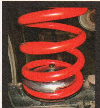
Normalmente, la gravedad y la masa del vehículo suspendida sobre los muelles son más que suficiente para mantener estos elementos elásticos perfectamente anclados a sus soportes inferiores. Pero si circulas a ritmo vivo en pistas, los saltos pueden llegar a permitir la extensión completa del muelle, que, según sea la forma de su anclaje, podría llegar a desplazarse de su soporte inferior. Una fijación mecánica solucionará este inconveniente.
