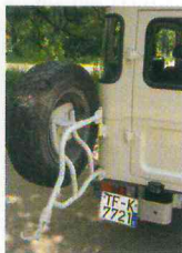
Los parachoques están realizados bajo el concepto de la mínima expresión. Especialmente las "omegas" de la parte posterior.
