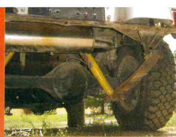
La suspensión por ballestas y los robustos ejes rígidos son parte de la fortaleza del vehículo.
