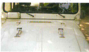
La carrocería de la Serie 40 es totalmente desmontable, prueba de ello son los anclajes que permiten fijar el parabrisas sobre el capó.
