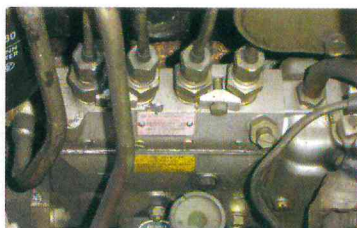
La bomba de inyección en línea otorga una presión cinco veces inferior a los modernos sistemas common rail.
