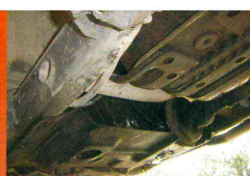
El freno de mano de tambor a la salida de la transmisión sigue el esquema de los todoterreno clásicos del siglo pasado.
