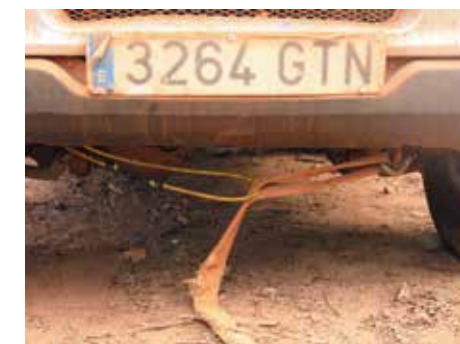
EXCÉNTRICO. Lo más probable es que el gancho de remolque frontal no esté centrado. Para evitar que la eslinga se enrede, es mejor que "reubiques" el tiro. Una barra rígida es la solución ideal (abajo), pero es poco probable que la tengas a mano.
