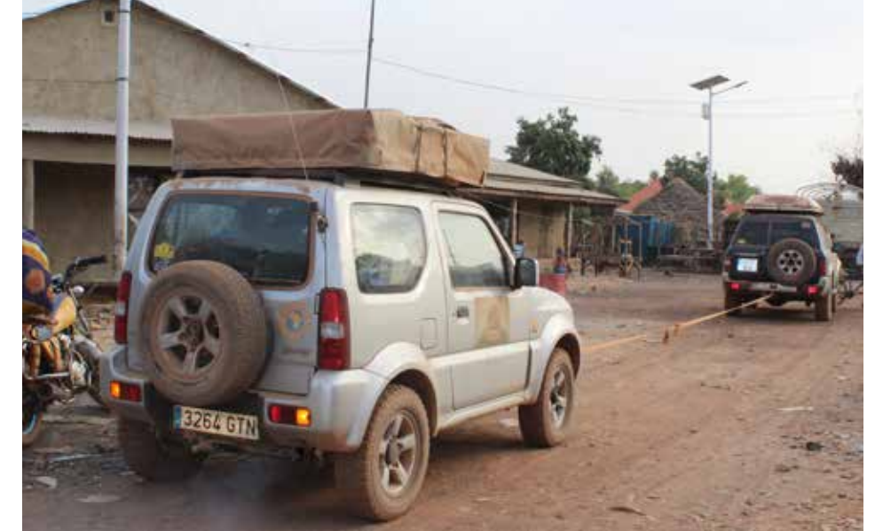
EXCÉNTRICO. Lo más probable es que el gancho de remolque frontal no esté centrado. Para evitar que la eslinga se enrede, es mejor que "reubiques" el tiro. Una barra rígida es la solución ideal (abajo), pero es poco probable que la tengas a mano.
