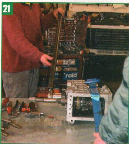
21 Sangler la boîte de vitesses sur l'établi et utiliser un bon bras de levier pour débloquer l'écrou de maintien de l'arbre intermédiaire avec une douille de 41 mm.
