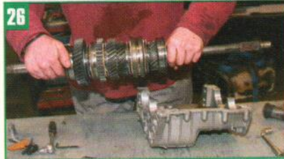
26 On dépose également les arbres primaire et secondaire.
