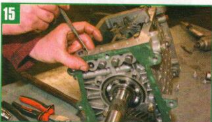
15 Ne pas oublier de récupérer les billes de verrouillage.
