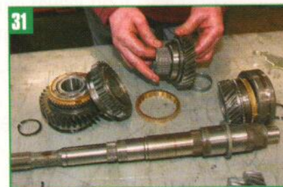
31 Inspecter soigneusement toutes les pièces et remplacer les plus défectueuses. Les roulements à aiguilles doivent être remplacés systématiquement.
