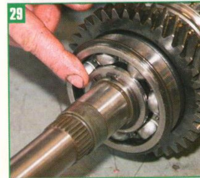
29 Pour démonter la pignonne de l'arbre secondaire, il faut retirer ce circlip.
