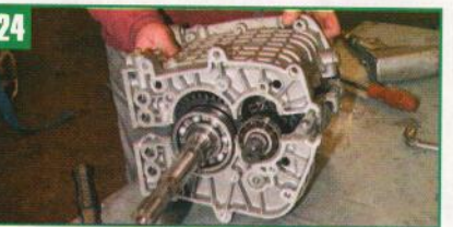
24 Séparer les deux demi-carters de boîte sur le modèle 22C.
