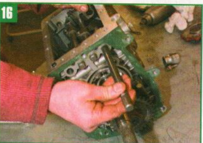
16 Déposer les rails de sélecteur selon l'ordre.
