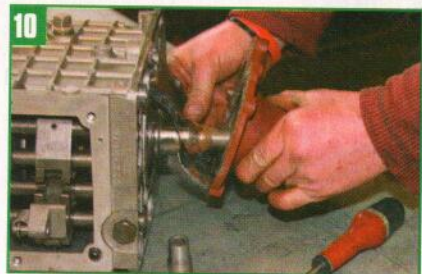
10 Sur le côté opposé de la boîte, déposer l'ensemble couvercle supérieur qui retient l'entretoise du palier avant de l'arbre intermédiaire.
