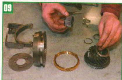
09 Bien repérer la position des différentes pièces.
