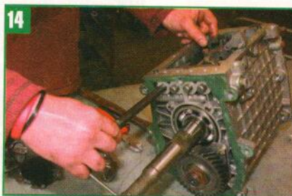
14 Les rails de sélecteur doivent tous être au point mort avant la dépose.
