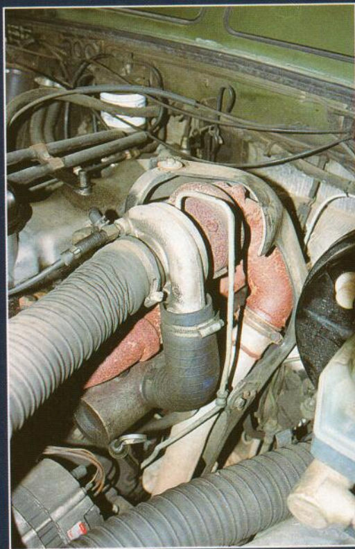
Le turbo Garrett T2 améliore de façon sensible les performances du moteur Rover Diesel.
